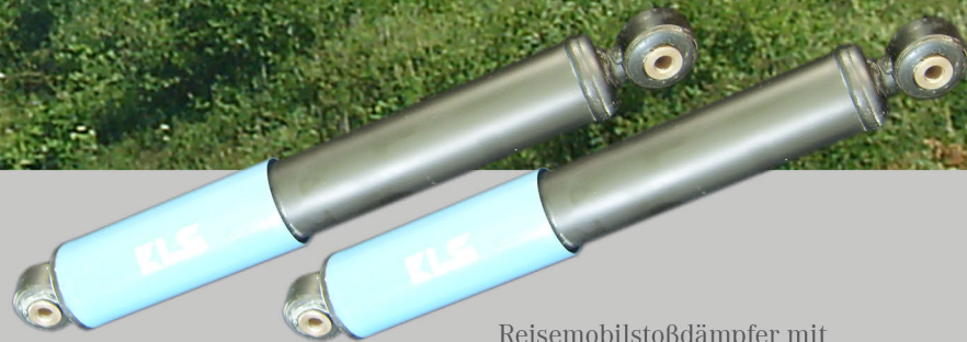
Reisemobilstoßdämpfer mit geänderter Zug/ und Druckstufe.
